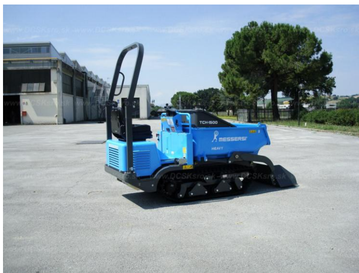
Obr. č. 5 Ukázka možného pásového stroje pro vnitrostaveništní dopravu.
