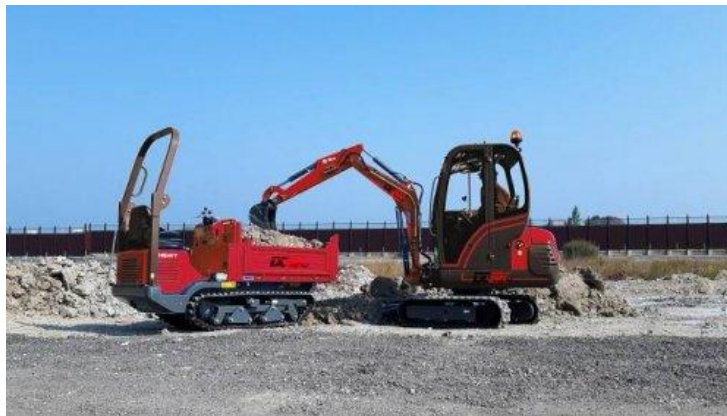
Obr. č. 7 Ukázka možné soupravy pásového mini-bagru + vyvážecího stroje.
