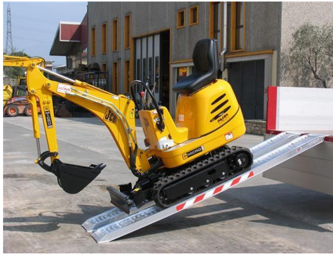
Obr. č. 6 Ukázka možného pásového mini-bagru s nosností ramene do 1,5t.
