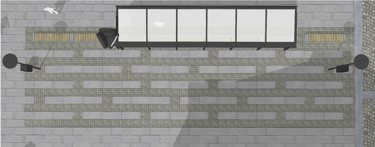
G Odpočinková plocha s autobusovou zastávkou - kombinace velkoformátové kamenné žulové dlažby 1000/400/80mm a žulových kostek 100/100/100mm, prostor pro umístění příležitostných uměleckých děl. Celkové rozměry 17,0 x 5,2m.
