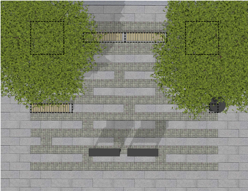
C Odpočinková plocha - kombinace velkoformátové kamenné žulové dlažby 1000/400/80mm a žulových kostek 100/100/100mm, informační tabule s historií města. Celkové rozměry 9,0 x 7,2m.
