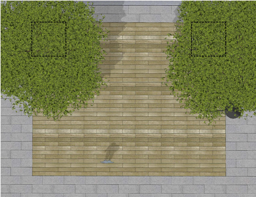
B Prostor pro umístění venkovního nábytku přilehlé restaurace v letních měsících. Betonová dlažba s dřevodekorem, 1200/200/80mm, odstín světle hnědý. Celkové rozměry 9,0 x 7,2m.
