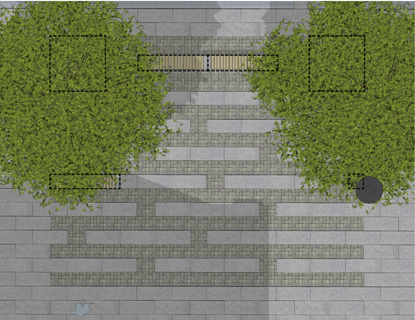
A Odpočinková plocha - kombinace velkoformátové kamenné žulové dlažby 1000/400/80mm a žulových kostek 100/100/100mm, prostor pro umístění příležitostných uměleckých děl. Celkové rozměry 9,0 x 7,2m.
