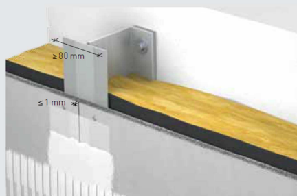
Spára mezi deskami kladenými na sraz (tloušťka spáry ≤ 1 mm) jako podkladu pro omítku
