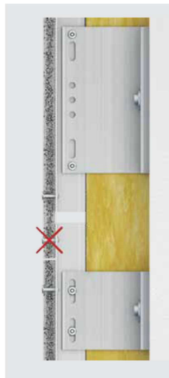
Detail A: Provedení pevných a kluzných bodů
