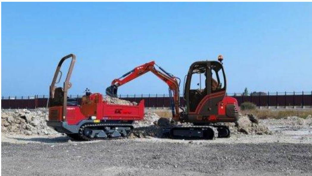
Obr. č. 7 Ukázka možné soupravy pásového bagru s nosností ramene co 3,5t + vyvážecího stroje.
