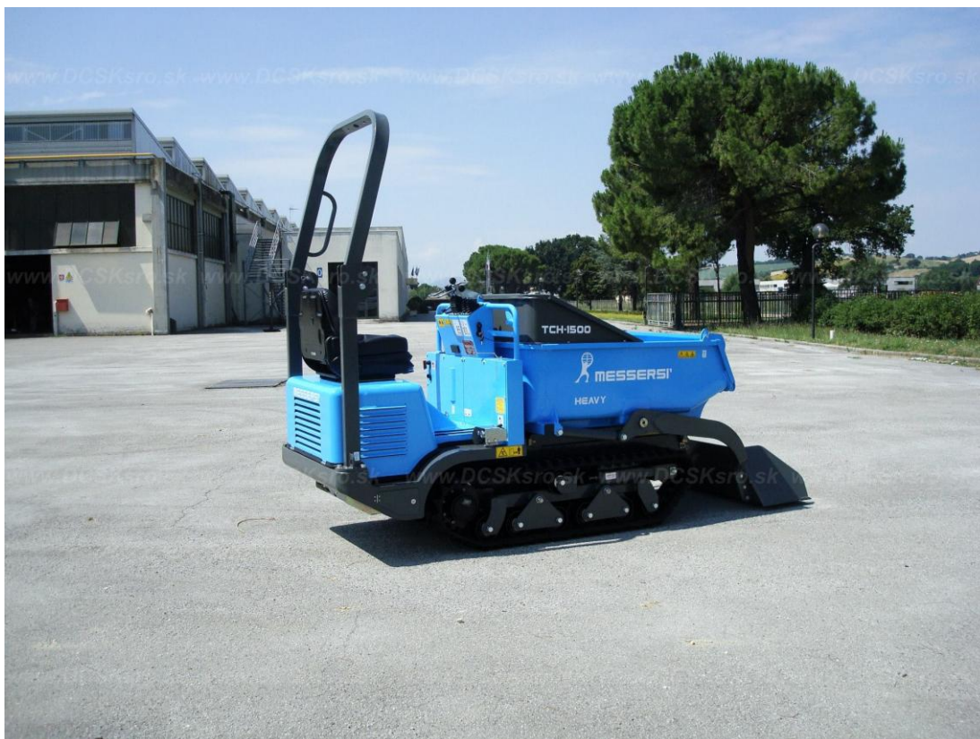
Obr. č. 6 Ukázka možného pásového stroje pro vnitrostaveništní dopravu.
